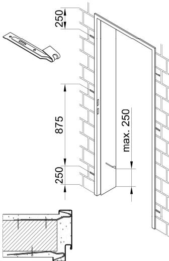
**Bild 13 Befestigungs- und Gegenanker**
