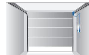
Antrieb in der rechten Torlaufschiene. Steuerung auf der rechten Garagenwand.
