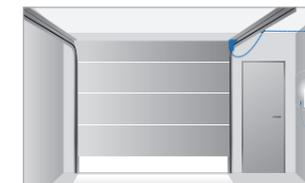
Bei verbautem Seitenanschlag, z.B. durch eine Nebentür, kann eine Kabelverlängerung eingesetzt werden.
