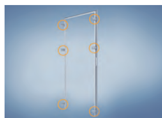
In der Standardausführung Vorderschale mit drei stabilen Trapezankern je Seite
