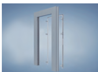
Vorderschale in die Öffnung schieben und ausrichten
