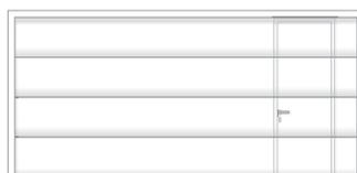
Agencement asymétrique pour les portes de largeur LHT comprise entre 2000 et 3500 mm - à droite ou à gauche du centre
