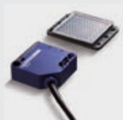
Barrière photoélectrique à réflexion Extra 628 • 24-240 V CA, 12-240 V CC, IP 54 • Portée 5 m • Utilisable uniquement comme émetteur
