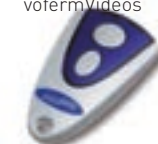
Télécommande Micro-Novotron 512 2 canaux, 433 MHz, code tournant KeeLoq
