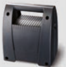
Pack d'accus Tension nominale 12 V CC, capacité nominale 15 Ah, durée d'utilisation 40 jours avec maxi. 4 ouvertures par jour et une température de 20 °C, plage de température de -15 à +45 °C, régulateur de charge intégré pour le bloc secteur • Convient au: Novomatic 423 Accu
