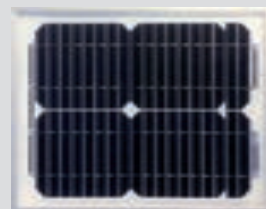
Module solaire Puissance Pmax 10 Wp, tension au repos 21.5 V, courant avec Pmax 0,5 A, dimensions 370 x 310 mm • Convient au: Novomatic 423 Accu
