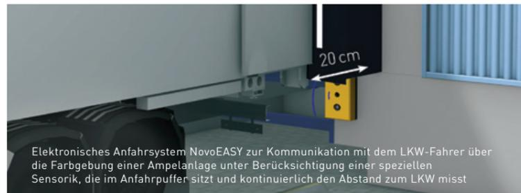
Elektronisches Anfahrssystem NovoEASY zur Kommunikation mit dem LKW-Fahrer über die Farbgebung einer Ampelanlage unter Berücksichtigung einer speziellen Sensorik, die im Anfahrpuffer sitzt und kontinuierlich den Abstand zum LKW misst
