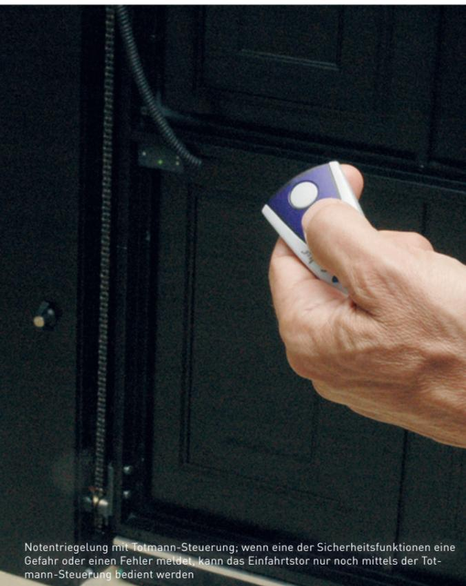
Notentriegelung mit Totmann-Steuerung; wenn eine der Sicherheitsfunktionen eine Gefahr oder einen Fehler meldet, kann das Einfahrtstor nur noch mittels der Totmann-Steuerung bedient werden
