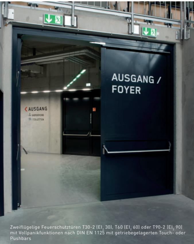
Zweiflügelige Feuerschutztüren T30-2 (EI<sub>2</sub> 30), T60 (EI<sub>2</sub> 60) oder T90-2 (EI<sub>2</sub> 90) mit Vollpanikfunktionen nach DIN EN 1125 mit getriebegelagerten Touch- oder Pushbars
