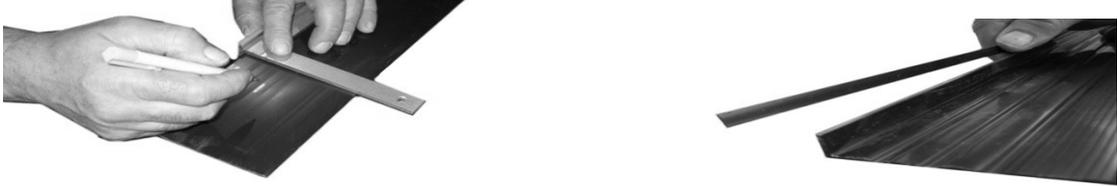
**4** Schutzfolie anlösen, Profil auf der Blende positionieren, anschließend Profil andrücken und die Schutzfolie abziehen
