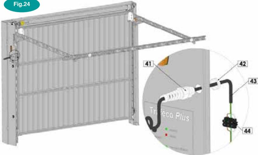
**G.9. METTRE** en place le presse-étoupe (41) avec son écrou (42) fournis dans le sachet accessoires sur la porte de la pile moteur (fig.24).
