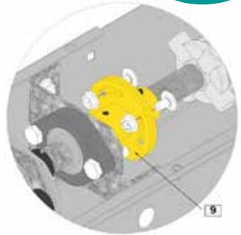
**C.5. INSERER** le tube coudé (16) dans le mandrin de tension du ressort (18) et le **MAINTENIR** en butée contre la traverse haute d'huissérie (66) (fig. 31).
