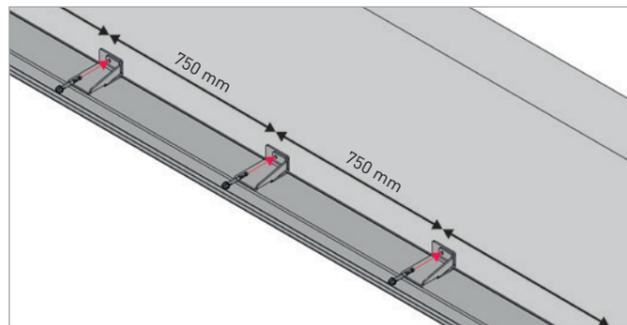
Einfache Montage durch Einzelkonsol-Befestigung mit vergrößertem Befestigungsabstand sowohl im Schließ- als auch im Öffnungsbereich von 750 mm ( $\geq 7.305$  mm: 500 mm). Einfacher Toleranzausgleich bei der Montage, durch Langlöcher in der Konsole und der Laufschiene.
