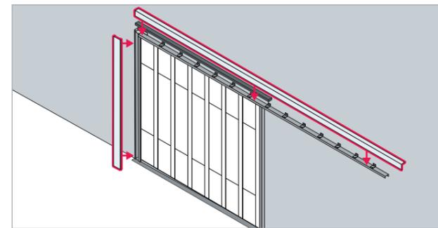
Einfache Laufschieneabdeckung im Standard enthalten, diese wird nicht sichtbar von oben verschraubt. Flächenbündig mit dem Gegengewichtskasten.
