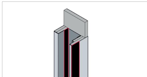
Weniger Komplexität durch werkseitig weitestgehend vorgefertigte Komponenten, in denen sogar z.B. schon die erforderlichen Aufschäumer-Streifen montiert sind.
