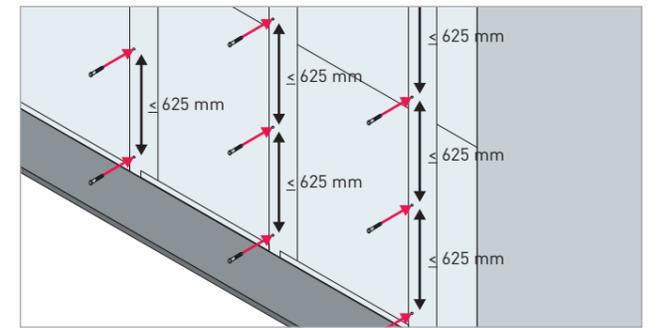
Verbindung der Paneele untereinander mit 1-seitiger Verschraubung auf der nicht sichtbaren Wandseite (Schraubenabstand  $\leq 625$  mm).
